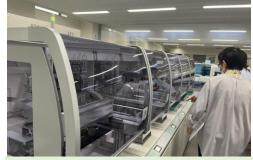
最新検査機器 血中濃度分析装置での検査前段階まで この機械で行うそうです 機械の素早い動きに目が奪われました
